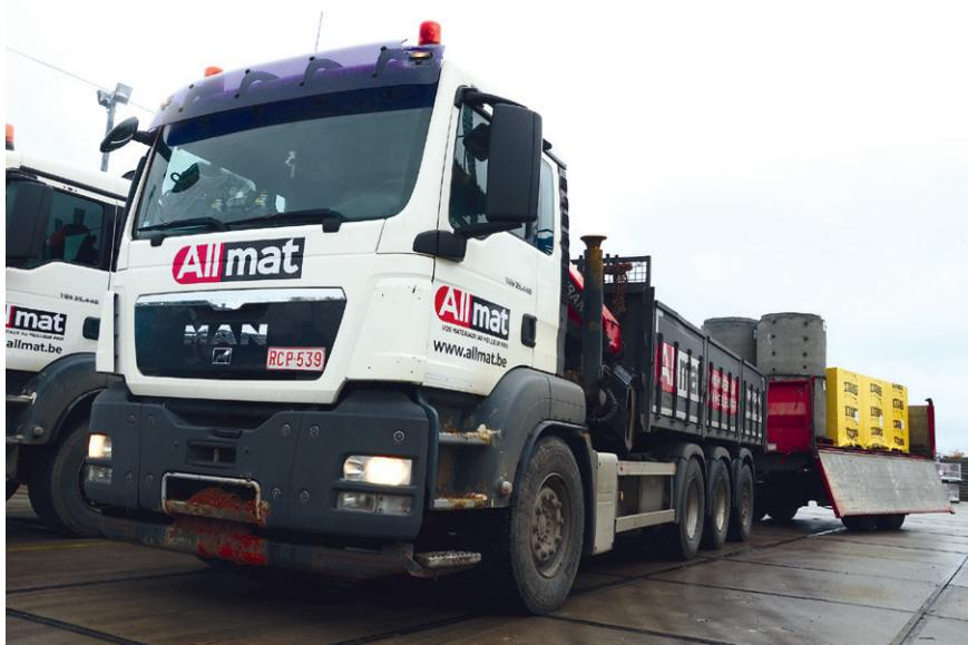
L'un des camions est équipé d'une grue dont la flèche monte jusqu'à 30 mètres, pour livrer par-delà les toitures des maisons en ville des charges allant jusqu'à une tonne.
