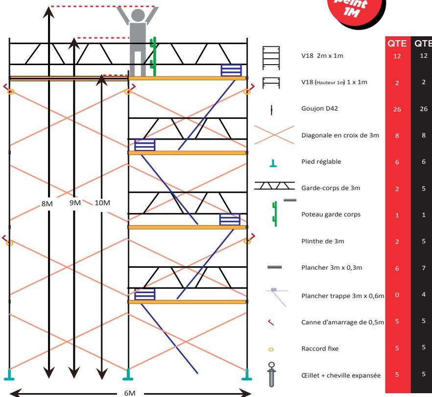
Conforme aux normes EN-12810 et EN-128111 Classe 4 (300kg/m<sup>2</sup>)
